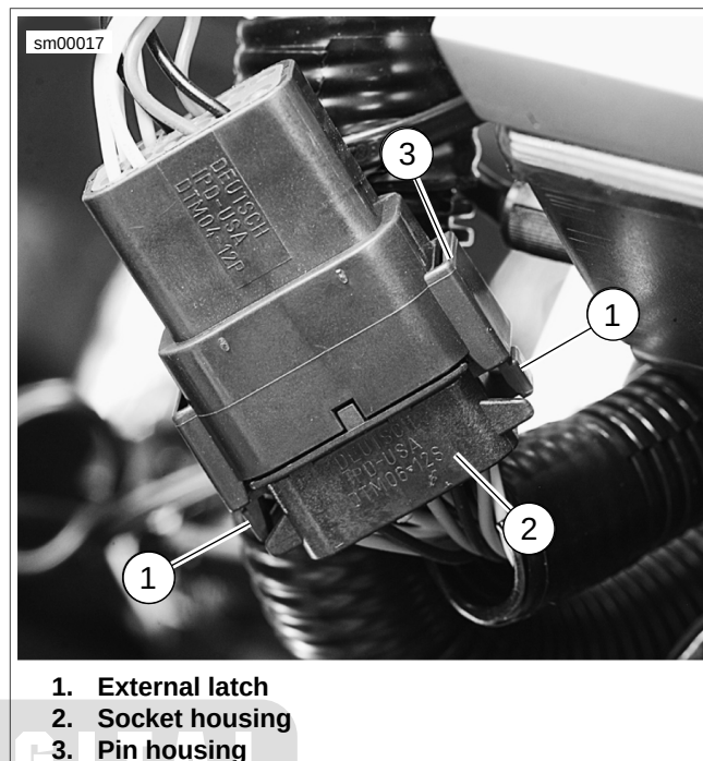
Figure A-13. Deutsch Connector
